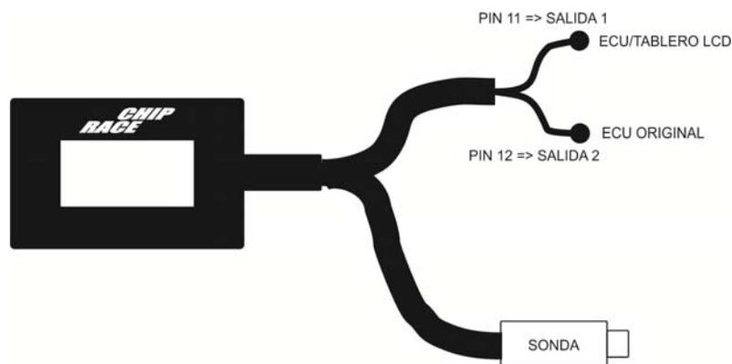
El Chip Race Wideband-O2 Meter & Datalogger posee además una salida CAN para poder conectarla a otros dispositivos compatibles. Esta salida se puede configurar en velocidad, ID, máscara y frecuencia de muestreo.
