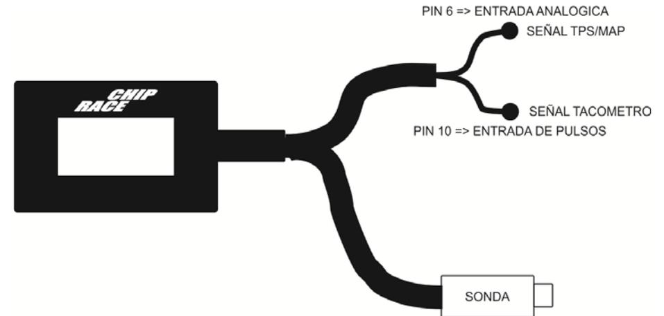
El Chip Race Wideband-O2 Meter & Datalogger posee dos salidas analógicas para interactuar con algún otro dispositivo como una ECU, etc. Una de las salidas tiene una señal de 0V a 5V proporcional al valor de Lambda y la otra representa la respuesta de una sonda lambda convencional para poder conectarla a una ECU original sin afectar el funcionamiento.
